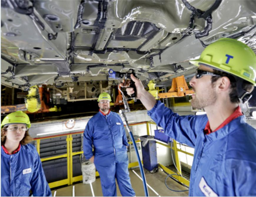
Des équipiers de Toyota montrent comment le PVC est pulvérisé sur le dessous de caisse d'une fourgonnette Sienna. Le PVC empêche la corrosion et les dommages causés par l'eau. Des équipiers ont réussi à réduire la quantité de PVC pulvérisé de 0,07 kilogramme (0,16 livre) par véhicule, sans nuire à la performance ou à la qualité. L'usine de montage en Indiana utilise maintenant 10885 kilogrammes (24000 livres) de PVC en moins sur les dessous de caisse des Sienna.
