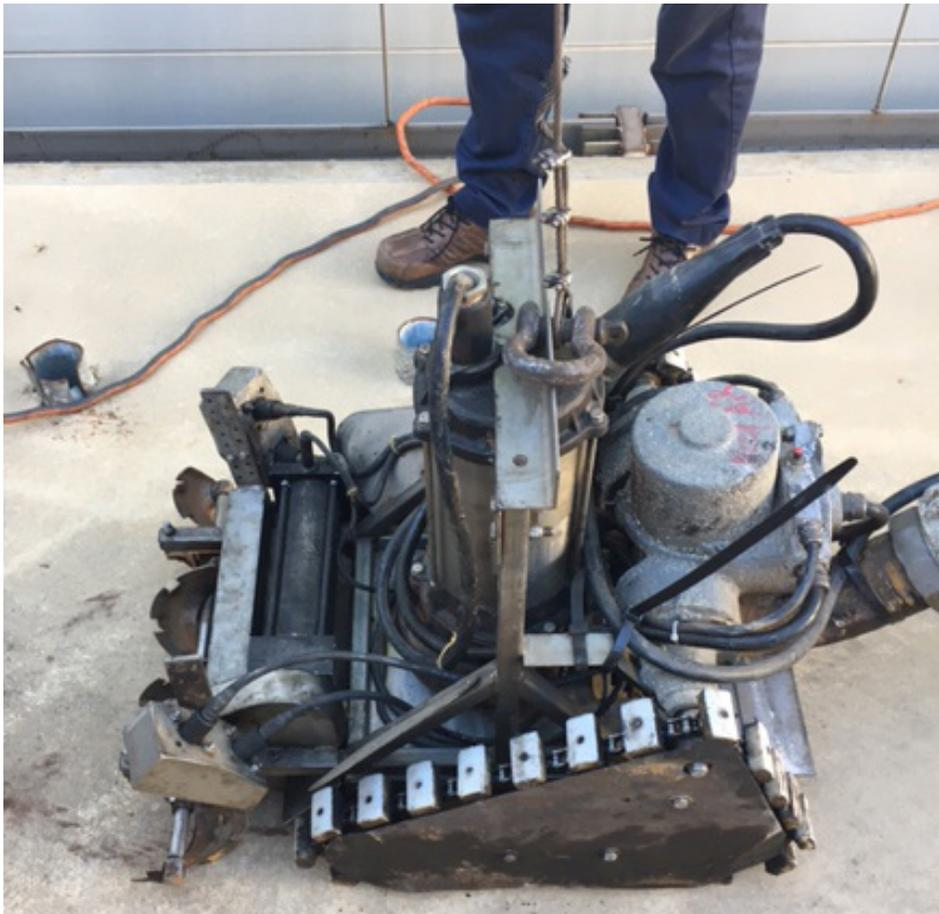
Ceci est le robot utilisé à l'usine de montage Toyota au Mississippi pour nettoyer la tour de refroidissement. L'utilisation du robot élimine le besoin de vidanger 300 000 litres (80 000 gallons) d'eau pendant le processus de nettoyage.
